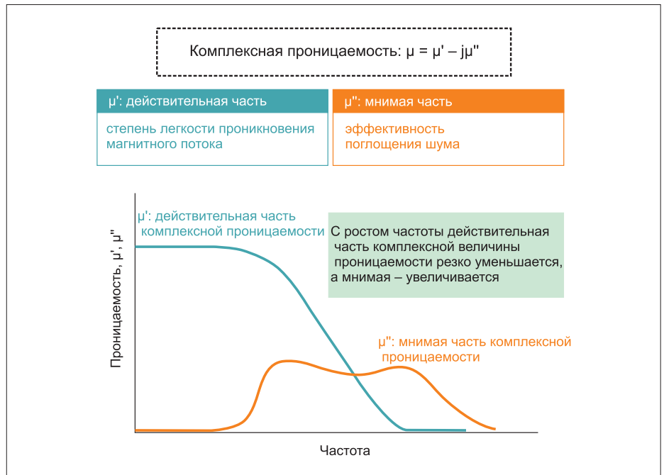
Рис. 3. Диаграмма показывает, как изменяется магнитная проницаемость под воздействием переменного магнитного поля
