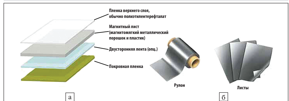
Рис. 2. а) типовое устройство ГЭП; б) формы, в которых производится поставка пластин
