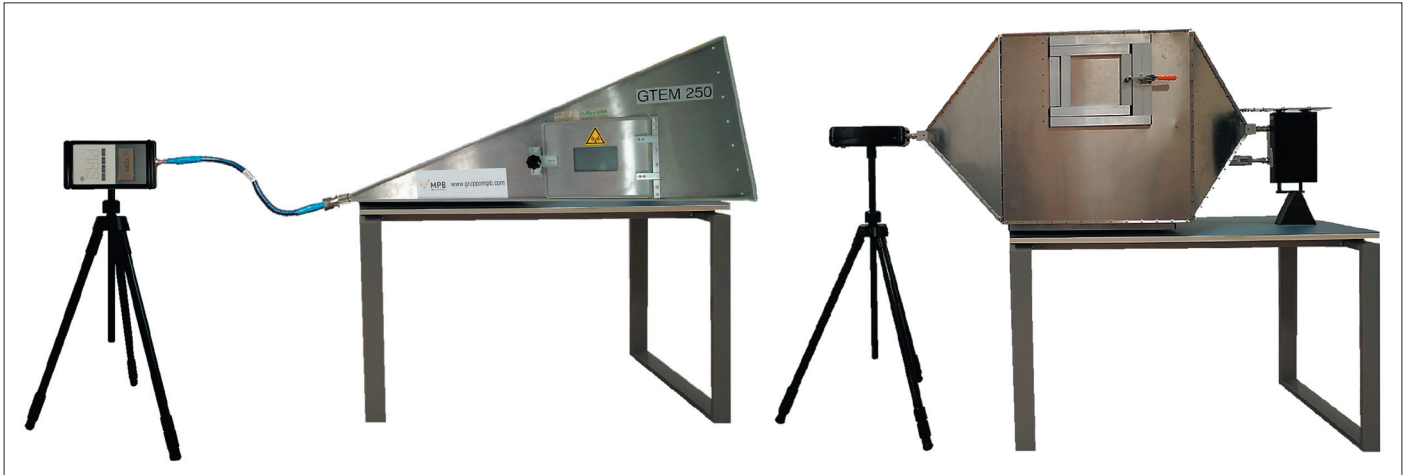
Рис. 3. Портативная система для испытаний на устойчивость к излучению. Бюджетное решение компании Emctestlab LLC [18]
