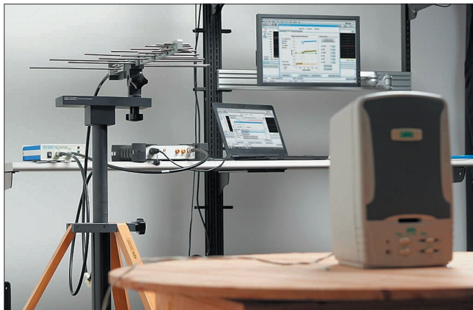
Рис. 5. Типовой набор для измерения уровня излучаемых ЭМП, подключаемый по шине USB анализатором спектра RSA500 компании Tektronix
