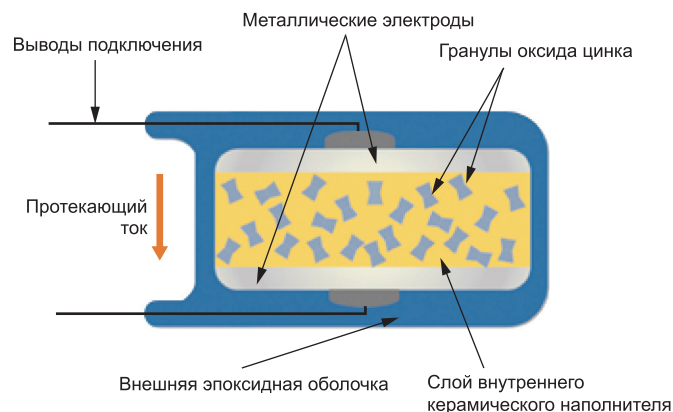
Рис. 2. Внутренняя структура варистора
